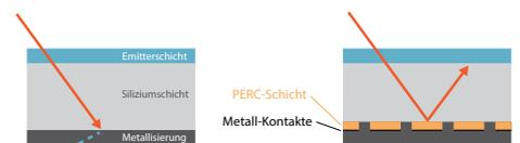
Bei herkömmlichen Solarzellen (links) wird ein Teil des Lichts von der Aluminium-Metallisierung absorbiert. Zellen mit PERC-Technologie (rechts) reflektieren das Licht an der Zellunterseite und generieren dadurch mehr Strom.
