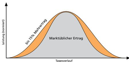
Dank modernster Spektralloptimierung leisten Megasol-Solarmodule bei Bewölkung und Dämmerung bis zu 15% mehr als marktübliche Module. Mit einem unschlagbaren Schwachlichtverhalten erzielen sie in der Praxis sehr hohe Jahreserträge.
