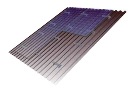
Schletter **SingleFix-V** ist eine sichere Befestigungsmöglichkeit für vertikale Modulmontage mit minimalem Materialeinsatz. **SingleFix-V** verfügt über eine Systemstatik und verwendet spezielle Schrauben mit Bauartzulassung und nachgewiesenen Befestigungskräften. In übersichtlichen Tabellen ersehen Sie sofort, wie die Befestigungselemente zu verteilen sind und welche Belastungen zulässig sind!
