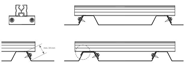
Die Montagefläche am Trapezblech muss min. 34mm Höhe betragen!
