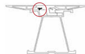
Die Diebstahlsicherung (rot) verhindert ein Aushängen der Module. Um diese im Servicefall zu lösen, haben wir ein spezielles Werkzeug entwickelt.
