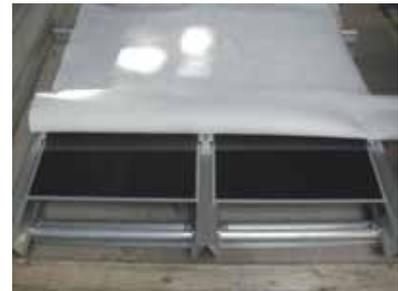
Beispiel Modulbelastungsprüfung mit Wassersack (Schletter) (Vorbereitung des Prüfaufbaus)
