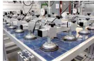
Beispiel Modulbelastungsprüfung mit Vakuumsauger (TÜV Rheinland)
