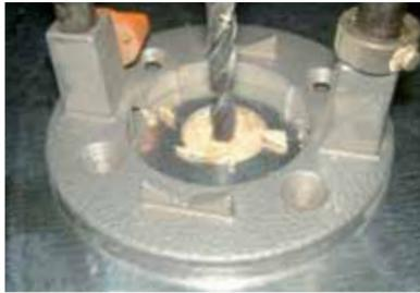
❶ Bohren der Blechbahn in ausreichendem Durchmesser (z.B. 30mm), anschließend Vorbohren der Stockschraube mit  $0,7 \times D$  (ca. 8,5mm). Verwendung einer geeigneten Bohrschablone zur Einhaltung der senkrechten Ausrichtung.
