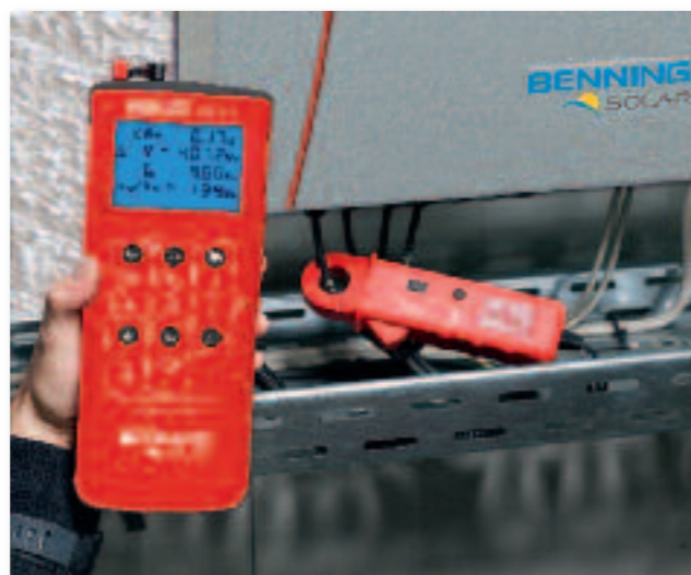
BENNING PV 1-1 – verschiedene Prüf- und Messverfahren zur Inbetriebnahme und Wartung (gemäß VDE 0126-23 (DIN EN 62446)), vereinfacht in einem intuitiv zu bedienenden Messgerät
